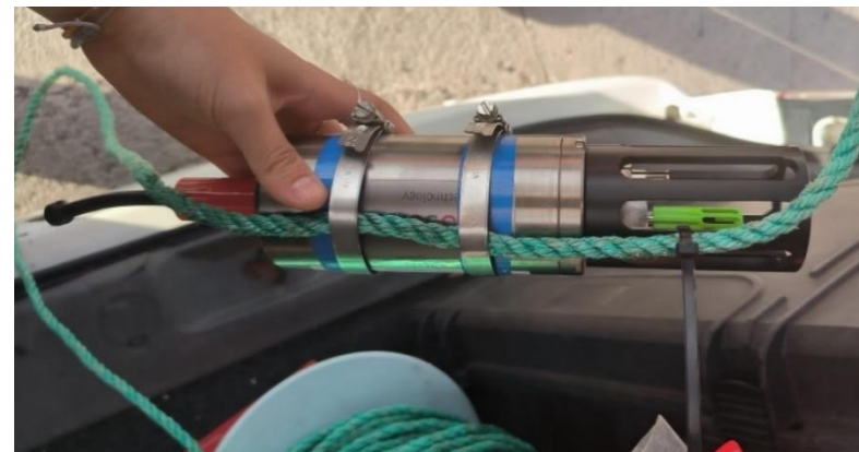
Sonda multiparamétrica para el análisis físico-químico del agua
