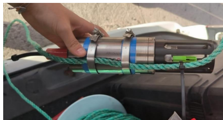
Sonda multiparamétrica para el análisis físico-químico del agua
